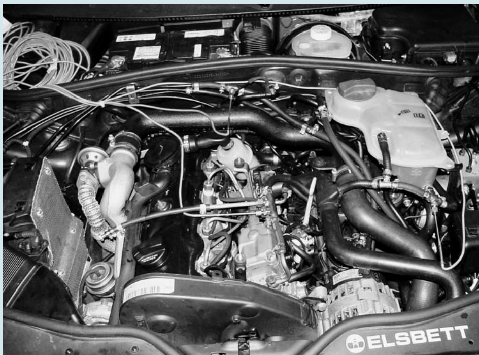
Abbildung 4: Temperatur- und Druckmessungen an Kraftstoffführung und Kühlflüssigkeit des Passat TDI des Autors. Die Messungen sind Grundlage zur Interpretation der Abgaswerte Trübung und \text{NO}_x .
